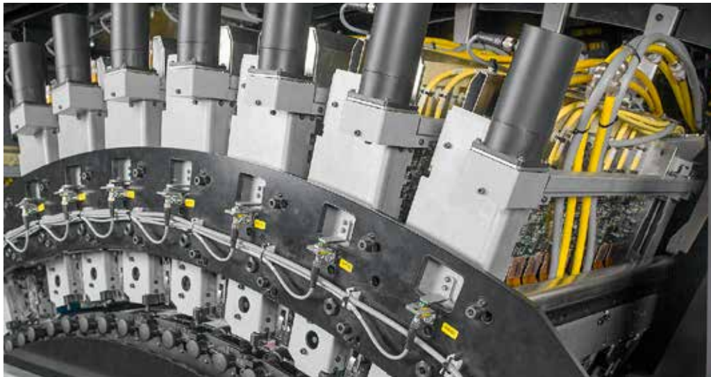
Achtfarbig angelegtes Drucksystem für eine maximale Farbraumabdeckung.
