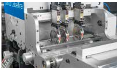
Optionale Längsschneider mit Rollmesser- oder Rasierklingenausführung möglich.
