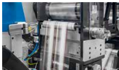
Semirotative Stanze mit Kompensator.
