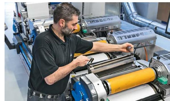
La chambre racle peut être facilement remplacée en quelques gestes.
