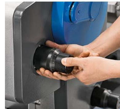
Le réglage manuel de la pression des cylindres d'impression est simple et rapide.
