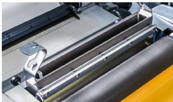
La chambre à encre est également adaptée aux vitesses d'impression élevées de façon à réduire la formation de mousse et à garantir un transfert d'encre optimal sur les anilox.
