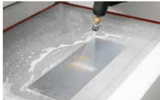
Nach dem Belichten wird die Siebdruckplatte mit Wasserhochdruck beidseitig auf einem bespannten, groben Polyestersieb entwickelt und getrocknet. Die Photoemulsion hat nach dem Trocknen einen Rz-Wert (Oberflächenrauheitswert) von **weniger als 5 Mikron**.
