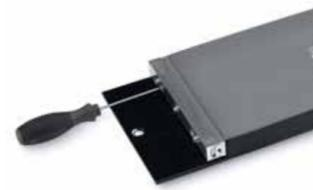
Die Siebdruckplatte wird in den **Schnellspanrahmen eingehängt** und mit Hilfe von zwei Klemmbacken fixiert. Im Anschluss wird die Siebdruckplatte mittels zwei Schrauben in einer Achse auf die **exakt** vorgegebene Federkraft **gespannt**. Der stabile, langlebige und gut isolierte Schnellspanrahmen ist **für alle Farbsysteme geeignet** und so konzipiert, dass er auf die gängigsten Siebdruckmaschinen aufgenommen werden kann. Sonderrahmen sind auf Anfrage erhältlich.
