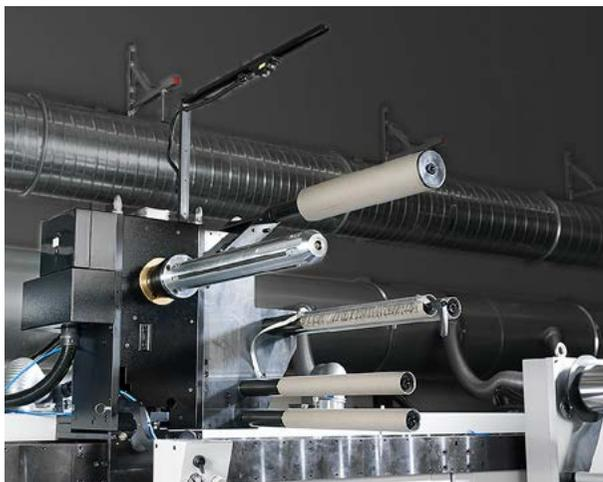
Un robusto sistema a rotaia agevola il montaggio e lo spostamento dei processi secondari.
