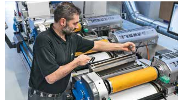
Mit nur wenigen Handgriffen lässt sich die Farbkammer bequem wechseln.
