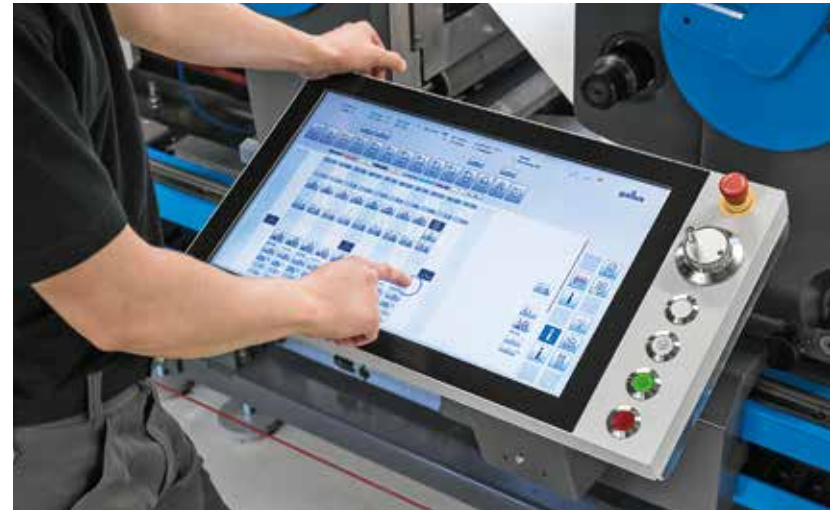
Das intuitiv bedienbare HMI-Touchpanel ist übersichtlich gestaltet und unterstreicht die einfache Bedienbarkeit der Gallus Labelmaster.
