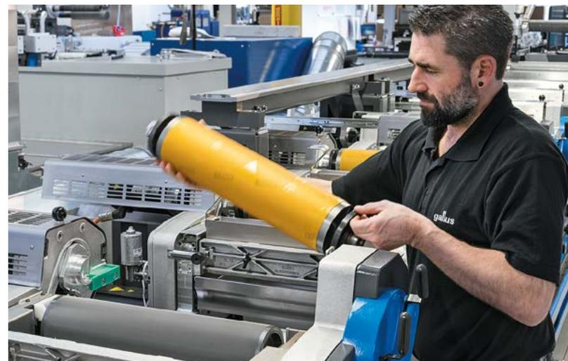
Il gruppo per la stampa flessografica della Gallus Labelmaster di nuova progettazione permette di cambiare molto velocemente i cilindri, riuscendo così a realizzare i cambi lavoro nel giro di pochi secondi.
