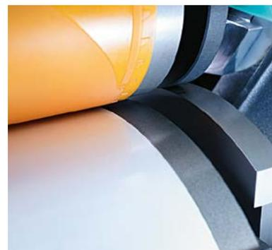
Massima precisione e robustezza dei nuovi cilindri con struttura leggera in alluminio e con anelli di rotolamento.
