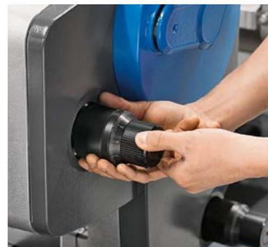
La regolazione manuale della pressione di stampa del cilindro di stampa si effettua con semplicità e precisione.
