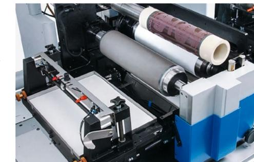
Gain de temps au calage grâce aux manchons pour cylindres imprimeurs et anilox. La chambre à racle prévue en standard facilite le changement d'encre.
