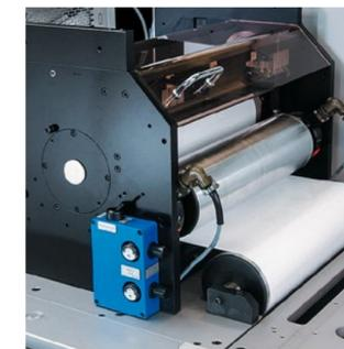
L'entraînement des cylindres imprimeurs et de la bande par des servomoteurs ultramodernes garantit à l'exploitant une très grande rentabilité et une flexibilité élevée quant aux substrats.
