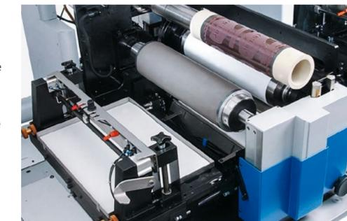
Tiempos mínimos de ajuste y de cambio de pedido para la impresión flexográfica, gracias a la tecnología sleeve para cilindros impresores y rodillo anilox. La cámara de rasqueta es estándar.
