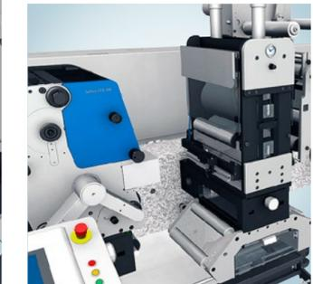
Ein kurzer Bahnlauf und Druckregister-Presetting ermöglichen schnelle Einrichtzeiten und wenig Makulatur.
