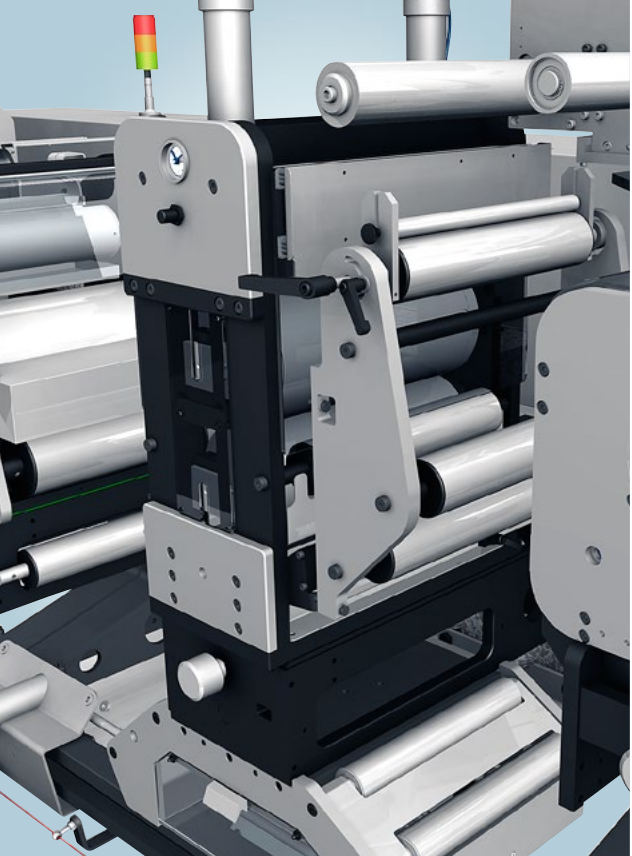
Nessun utensile per punzonatura dipendente dal formato grazie alla fustella semirotativa.
