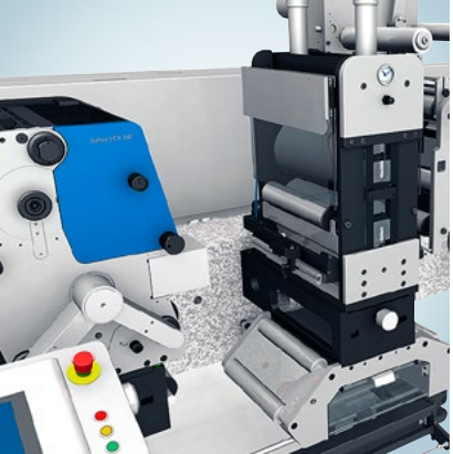
Breve percorso del nastro e predisposizione del registro di pressione per ottenere scarti ridotti e rapidi tempi di allestimento.
