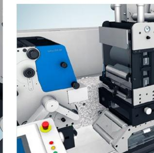
Passage-papier court et pré réglage du registre d'impression, d'où une réduction de la gâche et des temps de calage.
