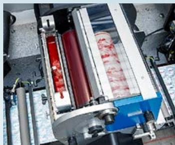
Las rasquetas de cámara permiten un cambio de tinta rápido.
