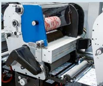
Las unidades de impresión accionados por servomotores permiten una máxima flexibilidad de soporte (también laminado tubular).
