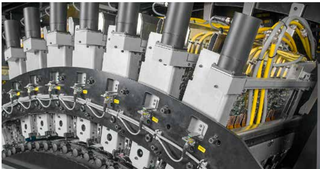
Sistema di stampa a otto colori per la massima copertura dello spazio colore.
