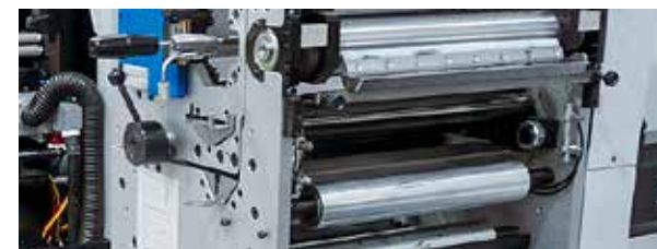
Semplice e affidabile: l'unità serigrafica servoassistita.
