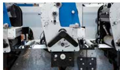
Le court trajet de 1,1 m assure le minimum de déchets et la rentabilité ainsi la plus élevée.
