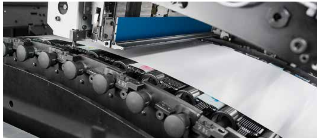
La forma única romboidal de los cabezales facilita una perfecta unión de los cabezales formando una franja cromática.
