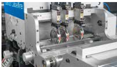
Es posible emplear un cortador longitudinal opcional con diseño de cuchilla rotatoria u hoja de afeitar.
