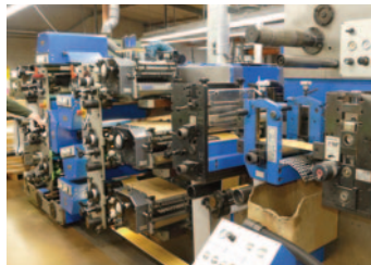
Für die Produktion von der Rolle stehen drei Generationen von Gallus-Maschinen zur Verfügung: die neue Gallus Labelmaster (l.), die Gallus R 160 und die Gallus T 330 S. Buch, Flexo- und Siebdruck kann damit praktiziert werden.
