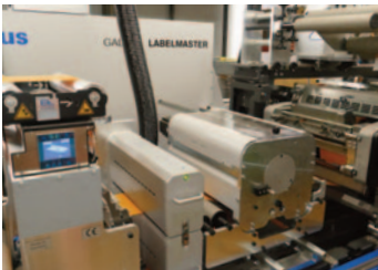
Für die Produktion von der Rolle stehen drei Generationen von Gallus-Maschinen zur Verfügung: die neue Gallus Labelmaster (l.), die Gallus R 160 und die Gallus T 330 S. Buch, Flexo- und Siebdruck kann damit praktiziert werden.
