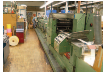
Für die Produktion von der Rolle stehen drei Generationen von Gallus-Maschinen zur Verfügung: die neue Gallus Labelmaster (l.), die Gallus R 160 und die Gallus T 330 S. Buch, Flexo- und Siebdruck kann damit praktiziert werden.
