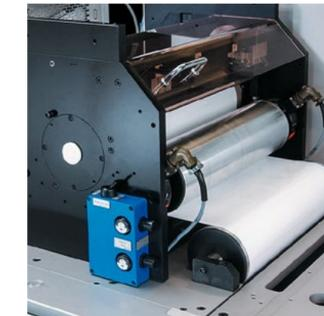
Alto grado di convenienza per l'utilizzatore e flessibilità del substrato garantiti dalla moderna tecnologia di servocomando per cilindri stampa e trasporto nastro.
