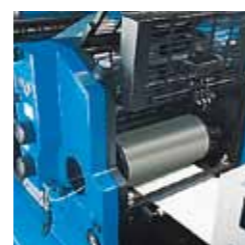
Rotasiebdruckwerk Gallus Rotascreen für hohe Farbschichtstärken oder effektvolle Bildelemente.
