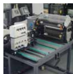
Flexible Kombination von Druck-, Bearbeitungs- und Veredelungsprozessen über gesamte Maschinenlänge – ohne Werkzeuge binnen Minuten wechselbar.
