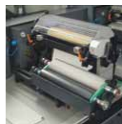
UV-Flexodruckwerk mit Easy Change: Minimale Einricht- und Umrüstzeiten und einfachstes Handling.
