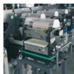
Schnellwechsel-Plattform erlaubt den einfachen Austausch von Druckwerken.
