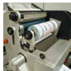
Tiefster Energieverbrauch und niedrigste CO 2 -Bilanz durch luftungsloses, wassergekühltes UV-Trocknungssystem.
